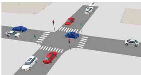
Рисунок 44 – 3D визуализация организации светофорного регулирования на 1500 секунде имитации на пересечении ул.Советская и ул.Кинешемская
