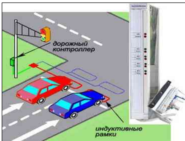
Рисунок 34 – Механизм работы электромагнитного детектора
