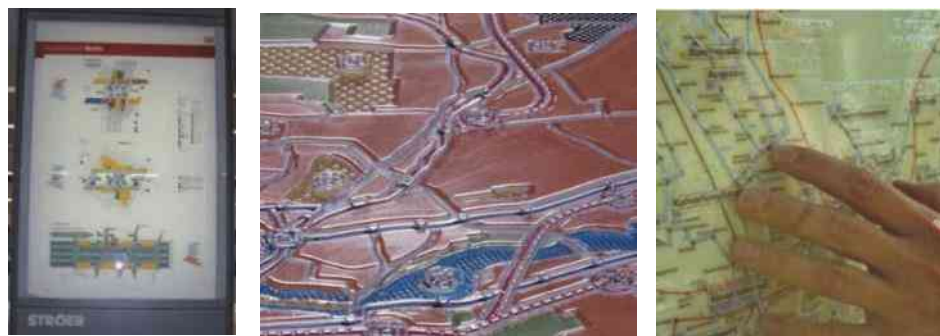
Рисунок 52 – Примеры выполнения тактильных указателей специального назначения
