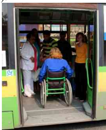
Рисунок 54 – Отсутствие площадки для представителя МГН в подвижном составе
