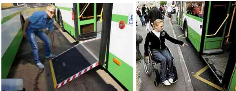
Рисунок 53 – Зазор между транспортным средством и бортовым камнем остановочного пункта
